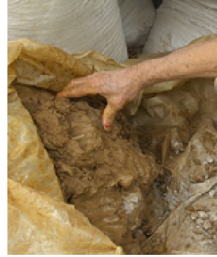
Resim 12. Mengele ve sakızlı toprağın yoğrulmuş hali.
