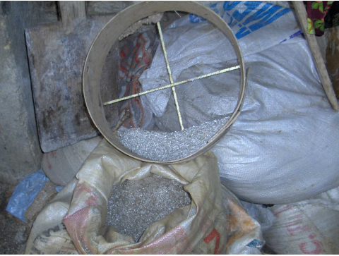
Resim 11. Mengelenin tokmakla inceltildikten sonra, tel bir elekten elenip çuvallara doldurulması.
