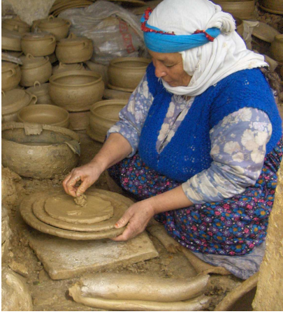
Resim 16. Taban koyma ve kıyı yuvarlama işlemi.
