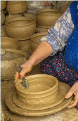
Resim 18. Çömleğin kılıçla şekillendirilmesi.
