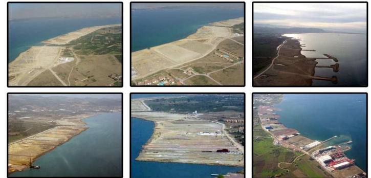
Foto 11: Hersek Deltasında, Günümüzde Tersane Sahası Olan Kıyıların Oluşturulması İçin Yapılan Dolgu Faaliyetleri ve Kıyı Kenar Çizgisindeki Değişimler
