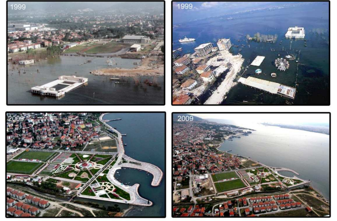
Foto 8: Gölcük-Kavaklı Mevkiinde 17 Ağustos 1999 Marmara Depremi Sonrasındaki Kıyı Çizgisi Değişimleri (Gölcük Belediyesi Arşivi)
