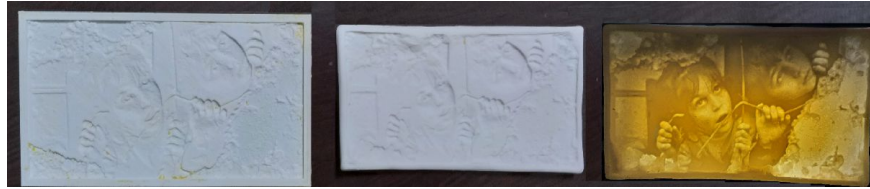
Görsel 13: CNC oyma işlemi yapılmış model, pişirimi yapılmış porselen plaka(arkadan aydınlatılmaz ve arkadan aydınlatmalı)
