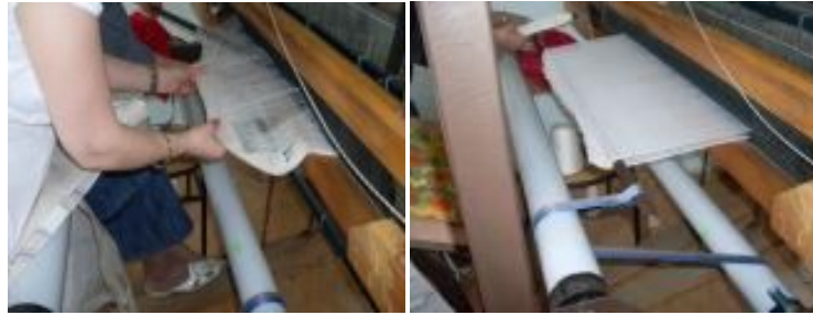
Figure 12. Threading the wrap beams again Fotoğraf 12. Çözümlenmelerinin yeniden levante takılması
