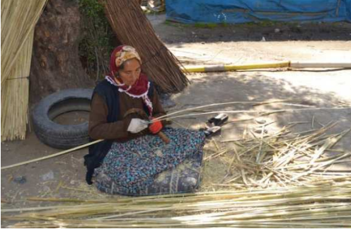
Resim 7: Orakla Kamışın Şerit Haline Getirilmesi.
