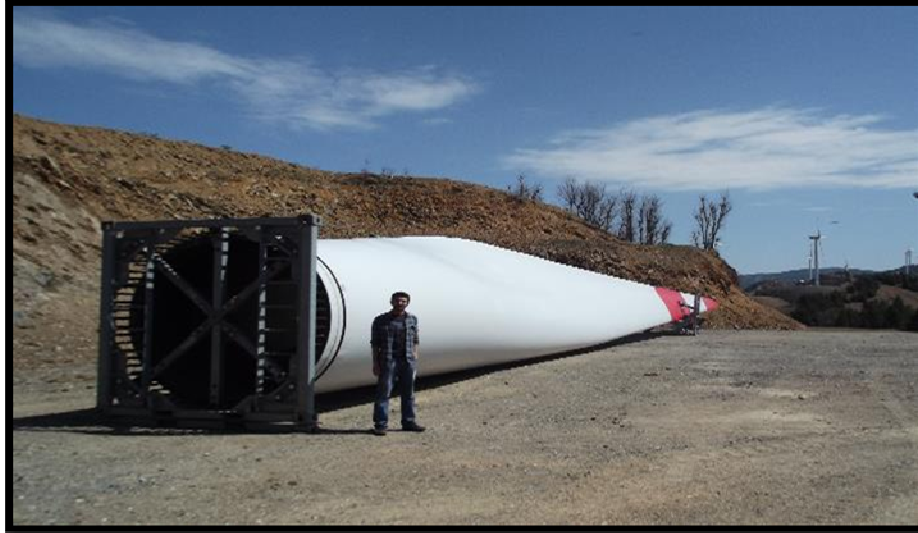
Foto 4: Arızalan Rüzgar Türbinlerinden Birinin Türbin Kanadı
